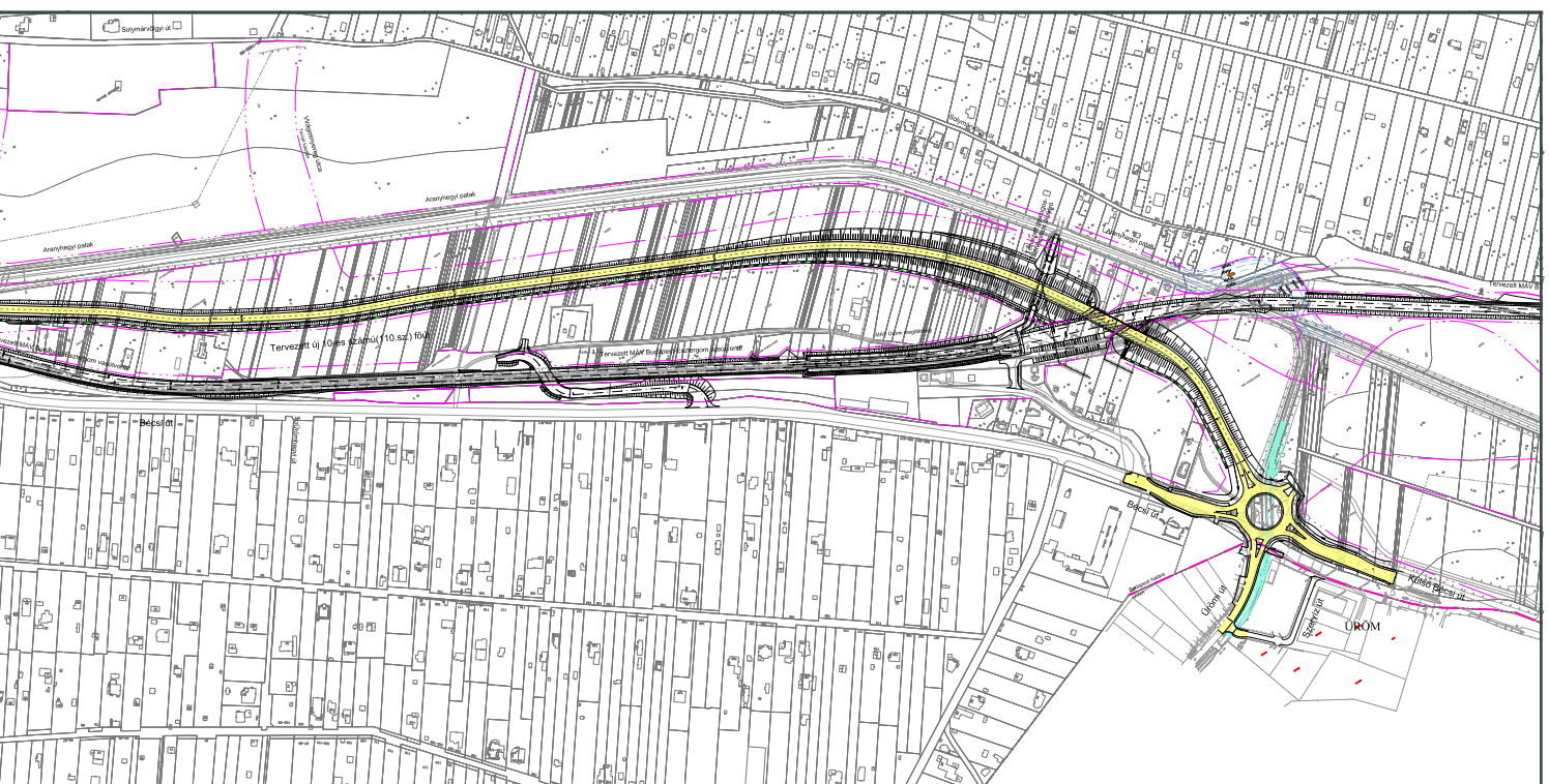
A 10-es út új nyomvonala az ürömi körforgalommal (jobb oldalon), valamint az Aranyvölgy utca és a Pomázi úti csomópont (bal oldalon) – forrás Uvaterv Zrt.
