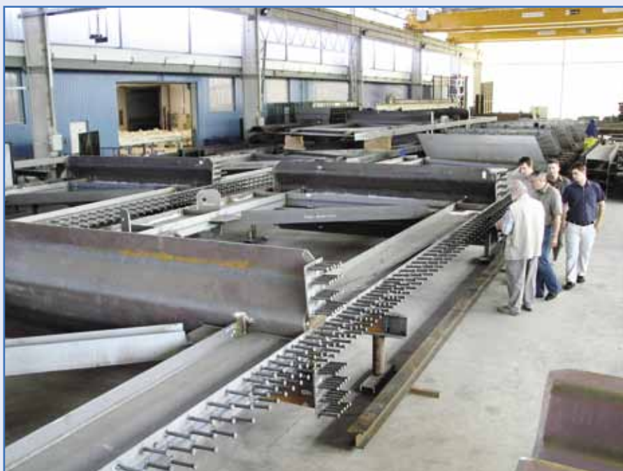
1. kép: Acél keresztartó a Rutin Kft. dombóvári szerelőcsarnokában
