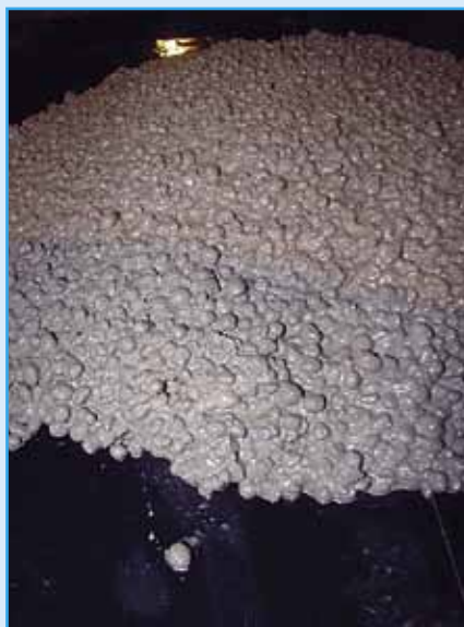
2. kép: Friss(könnyű) beton
