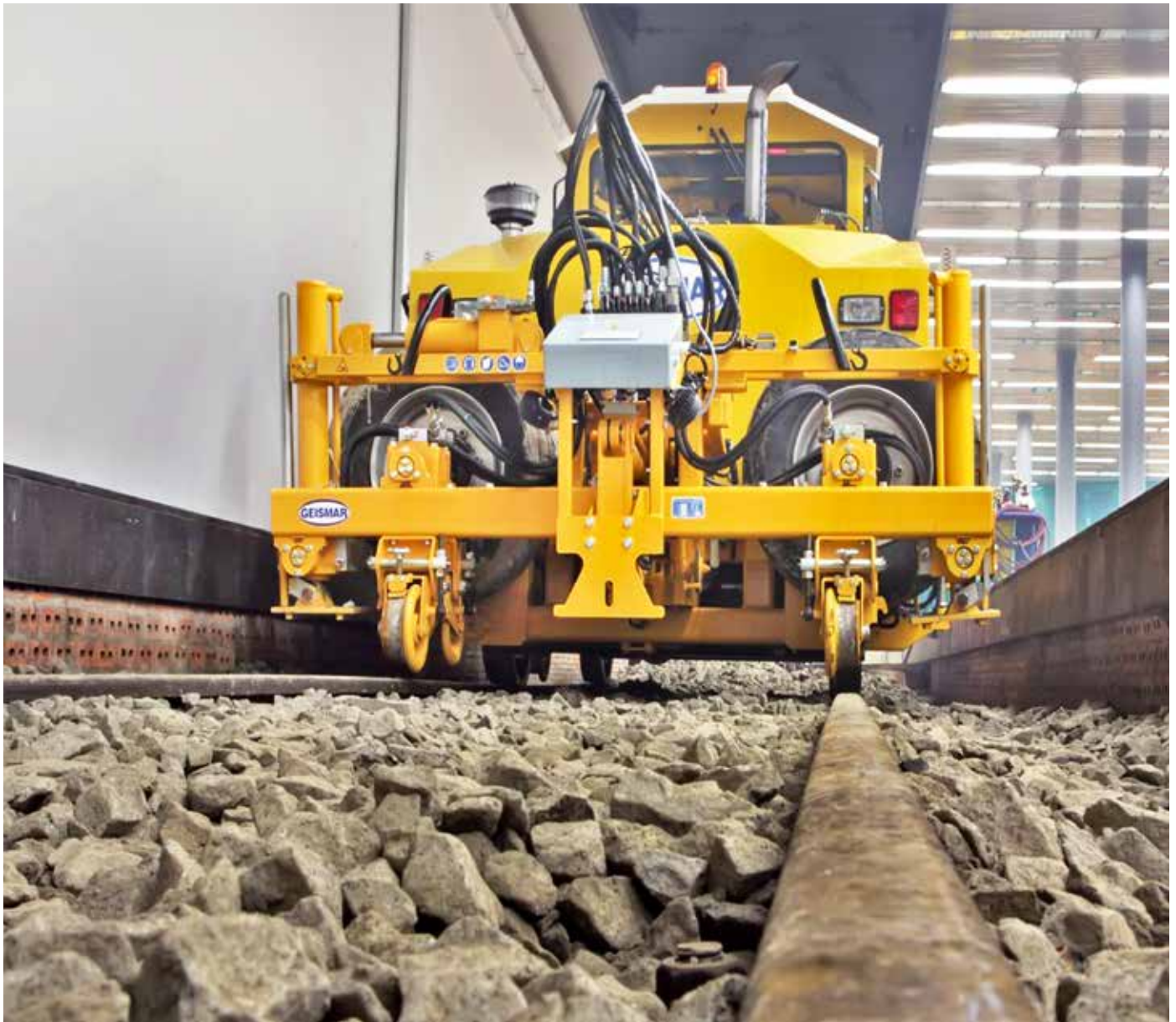
BRM 8 AC típusú vágány- és kitérő szabályozó kételtű gép
