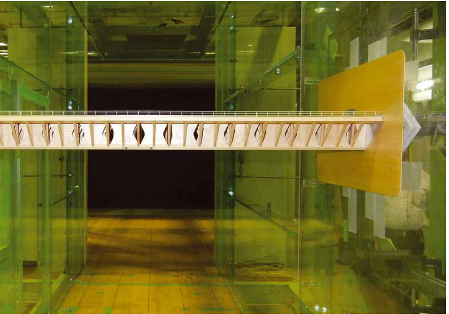
17. Pillangóbordás-híd-modell: Szélcatornás vizsgálat
