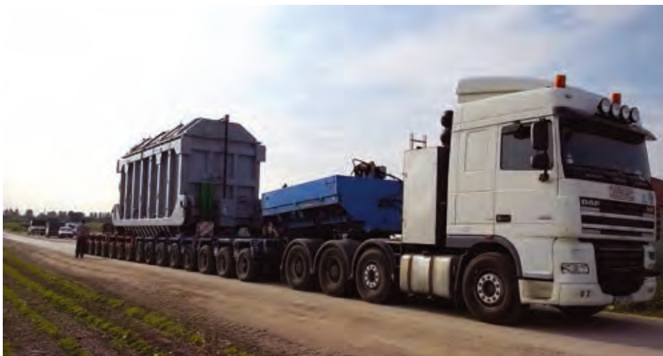
Így érkezett közúton a 150t fölötti transzformátor
