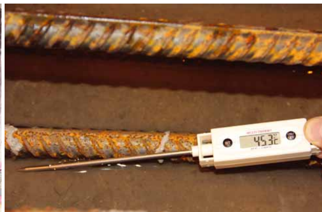
A modell elem hőmérsékletének ellenőrzése
