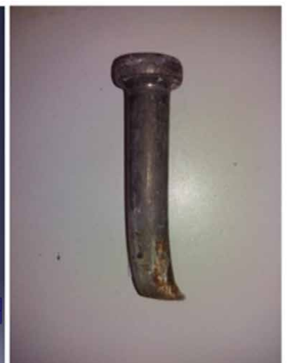
Tönkremenetel jellege a numerikus és a laboratóriumi kísérlet során
