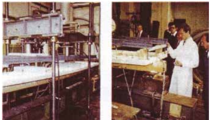
8. ábra: Fa-acélszálbeton öszvértartó-szerkezetű földemgerendákon a 80-as években végzett laboratóriumi vizsgálatok elrendezése a Bécsi Műszaki Egyetem Kísérleti és Kutatási Intézetének laboratóriumában
